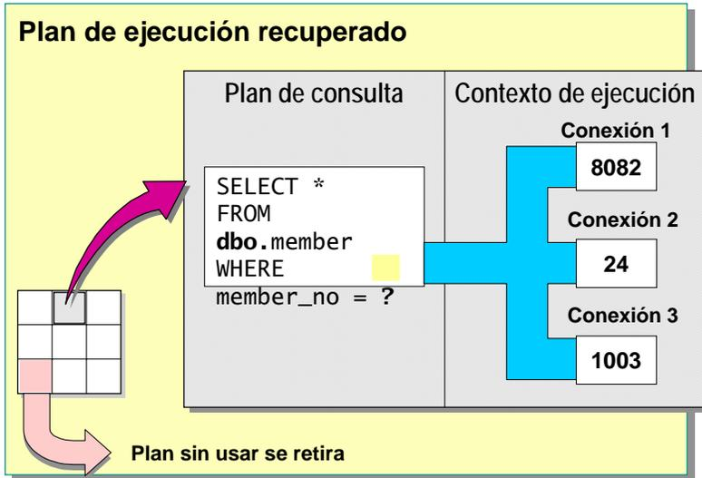
El proceso posterior de los procedimientos almacenados es más rápido que el inicial porque SQL Server utiliza el plan de ejecución optimizado de la caché de procedimientos.
